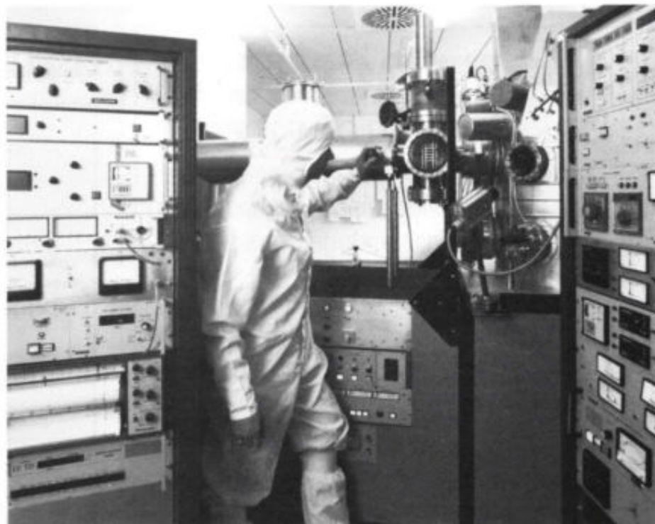
Overzicht van de MBE-installatie die in het AEG-laboratorium wordt gebruikt voor het opdampen van extreem dunne epitactische structuren.
