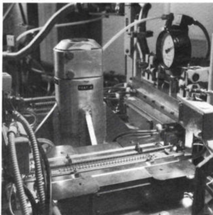
Hermetische afsluiting van reedschakelaars in glazen omhulling (foto: Philips).
