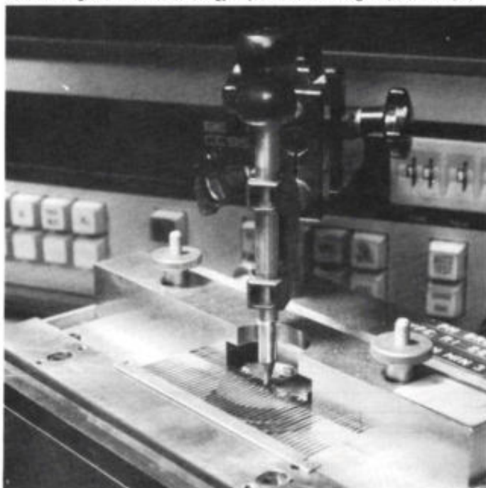
Diktemeting van het contactlaagje op de schakeltongen (foto: Philips).
